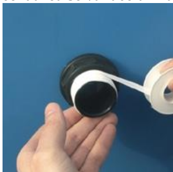
Etansarea cu teflon
